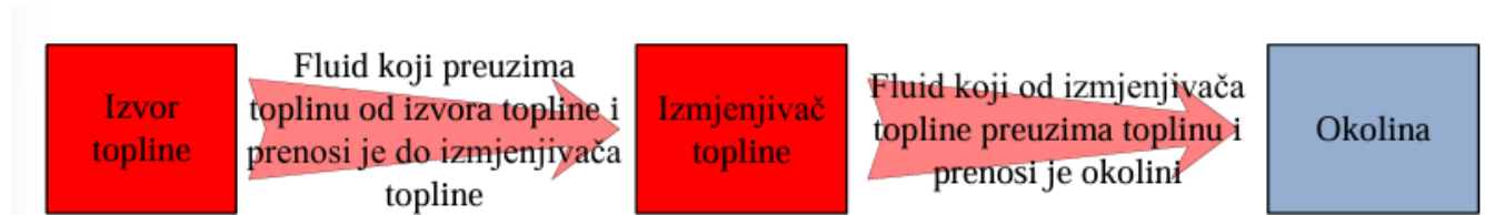
Slika 5.2. Blok shema procesa odvođenja topline od izvora topline do okoline
