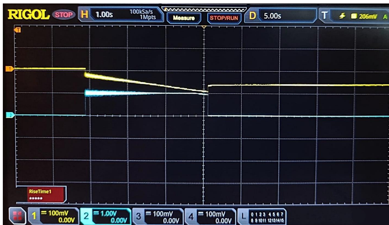
Slika 8.4. Prikaz strujne i naponske karakteristike hibrida baterije i superkondenzatora sa horizontalnom vremenskom bazom 1 s i horizontalnom pozicijom 5 s
