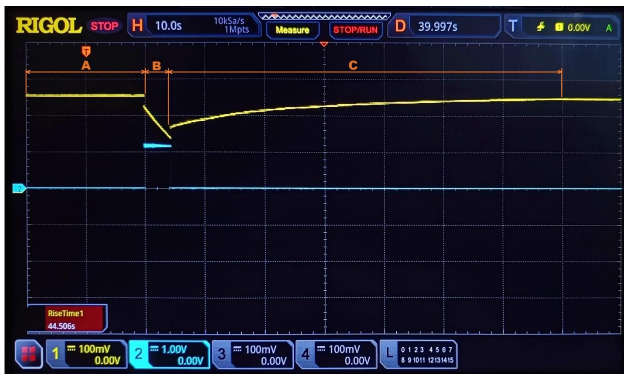
Slika 8.7. Prikaz strujne i naponske karakteristike hibrida baterije i superkondenzatora sa horizontalnom vremenskom bazom 10 s i horizontalnom pozicijom 39.997 s
