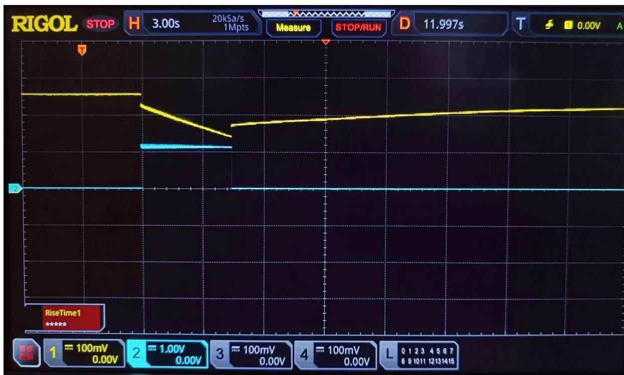
Slika 8.5. Prikaz strujne i naponske karakteristike hibrida baterije i superkondenzatora sa horizontalnom vremenskom bazom 3 s i horizontalnom pozicijom 11.997 s
