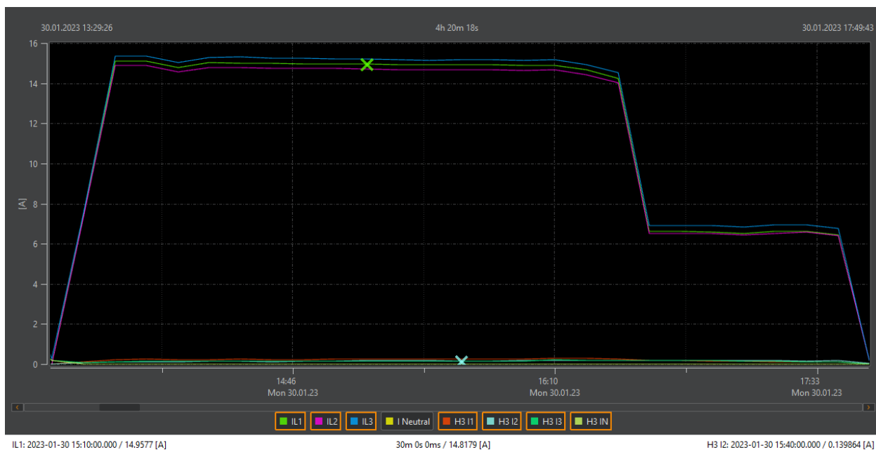
Slika 5.12. Dijagram efektivne vrijednosti struje i 3. harmonika za vrijeme trofaznog punjenja
