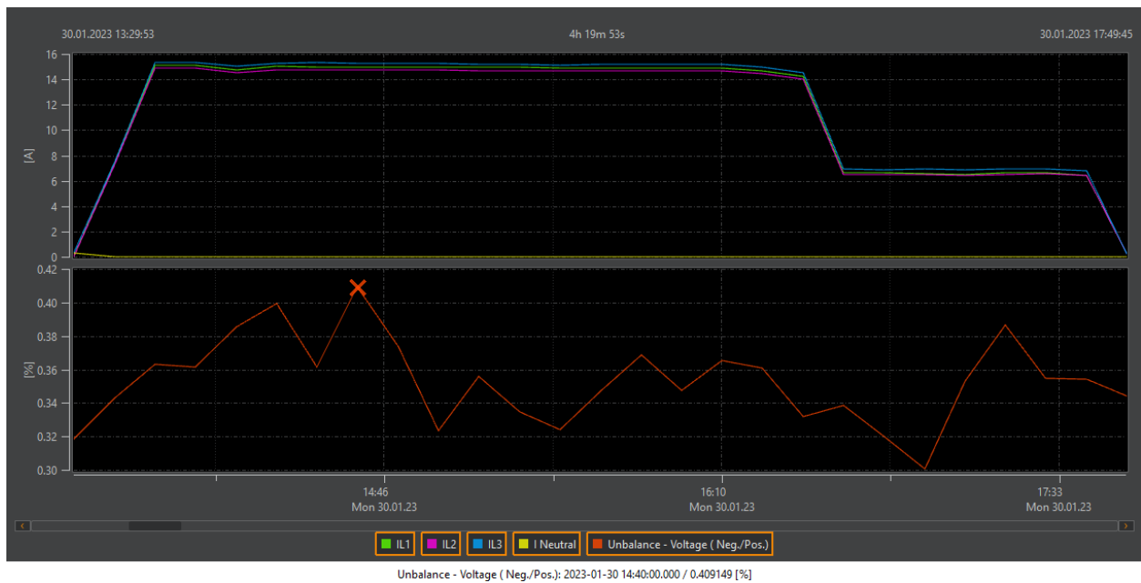
Slika 5.18. Nesimetrija napona pri trofaznom punjenju
