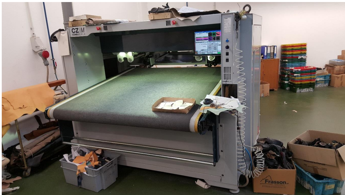
Slika 3.4. CNC rezač CZ/M proizvođača Comelz [2]
