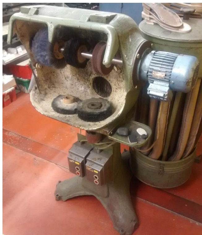
Slika 3.18. Stroj za četkanje [2]
