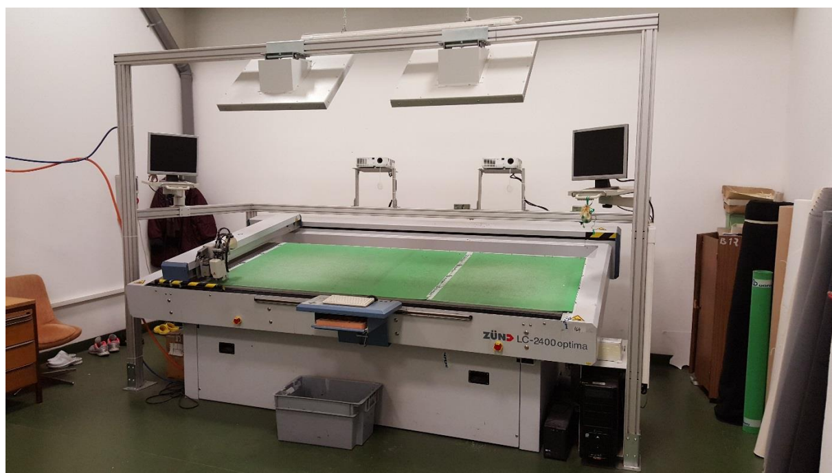
Slika 3.3. CNC rezač LC-2400 optima proizvođača Zund [2]
