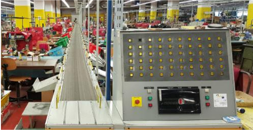
Slika 3.10. Šivaća transportna traka Volonte tip VDN/125/40 [2]
