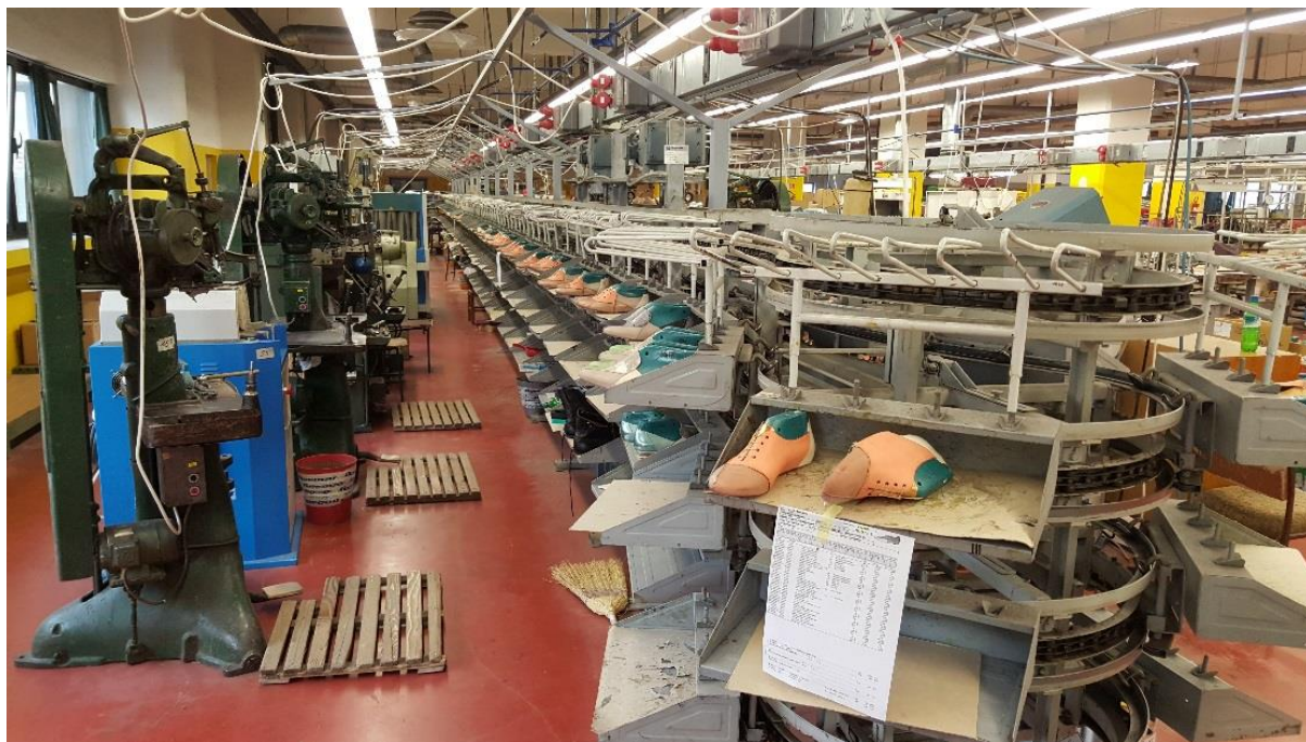
Slika 3.13. Linija za sastavljanje obuće, tzv. konfekcijski krug [2]
