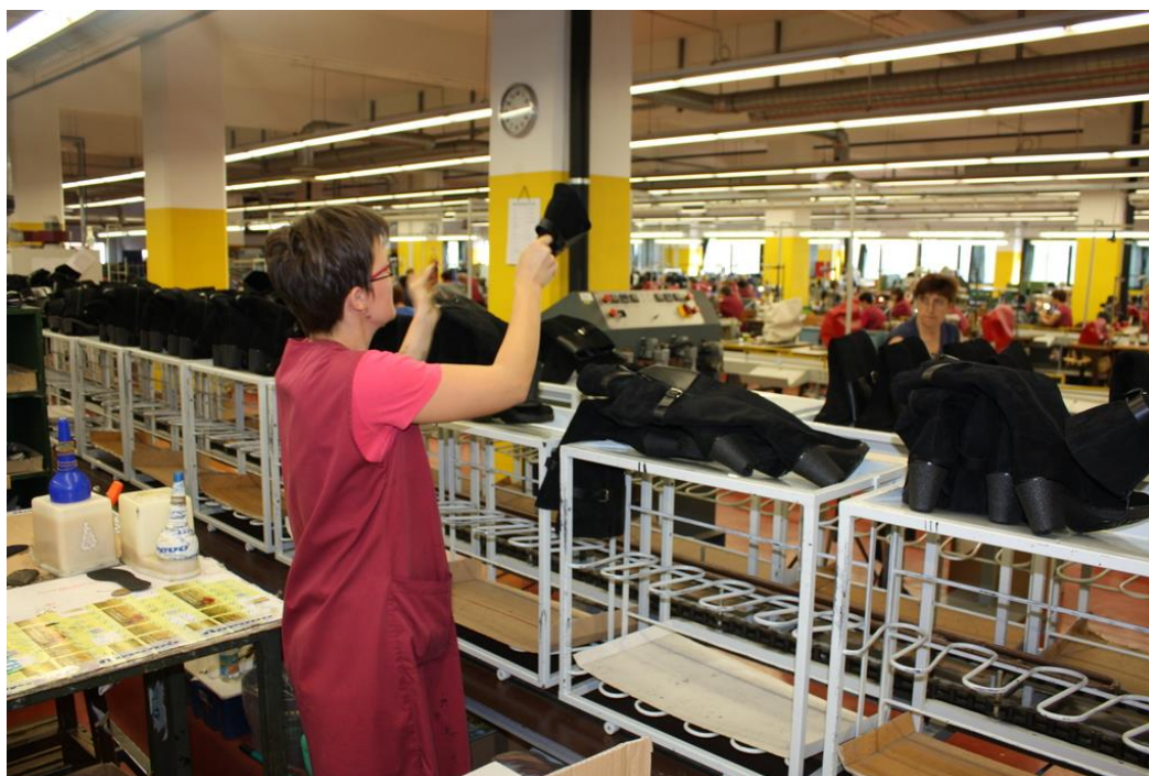
Slika 3.19. Mali konfekcijski krug za kontrolu kvalitete u završnoj obradi [2]
