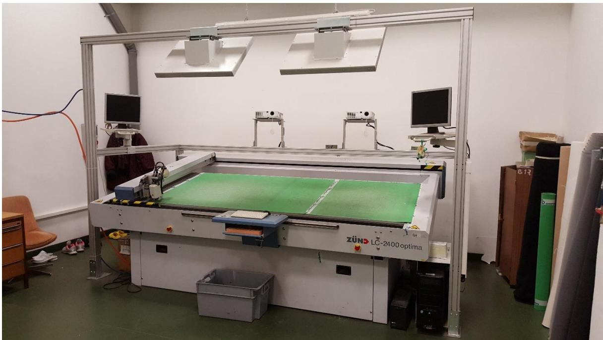
*Slika 3.3. CNC rezač LC-2400 optima proizvođača Zund [2]*
