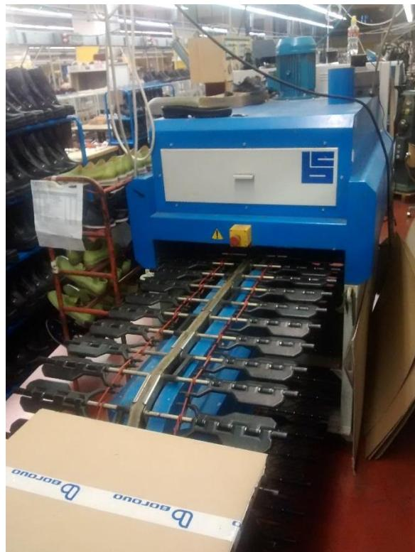
*Slika 3.17. Stroj za sušenje [2]*
