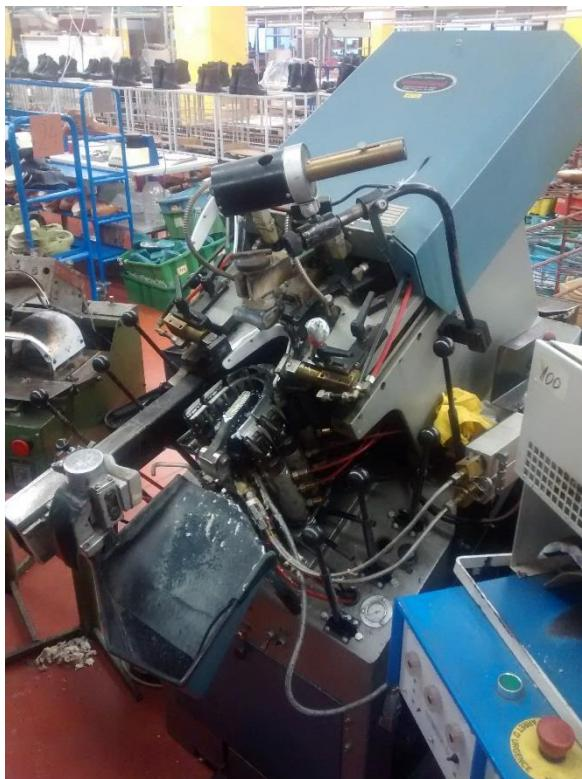
*Slika 3.15. Stroj za navlačenje vrha lijepljenjem, International SH-LTF [2]*
