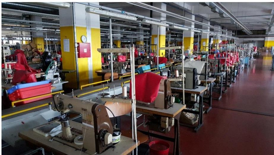
*Slika 3.9. Šivača radionica sa visokim šivaćim strojevima tip PFAFF 471 [2]*
