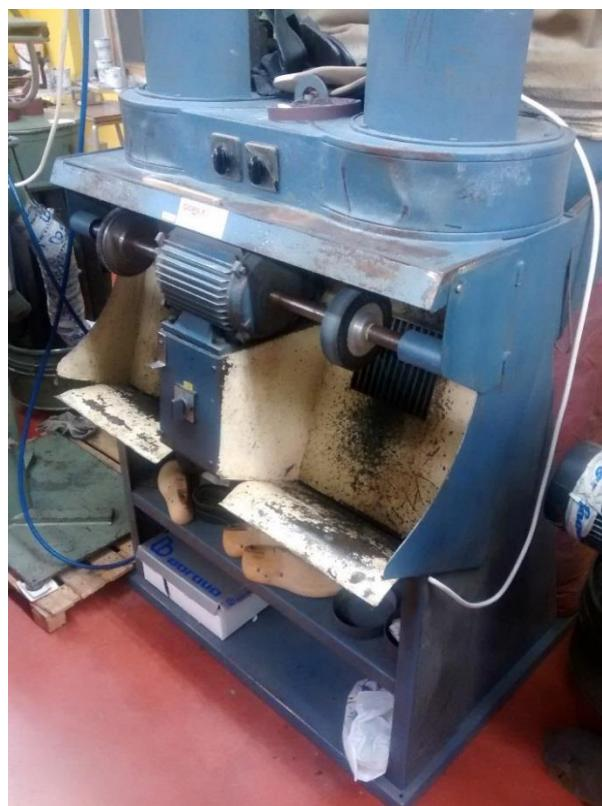
*Slika 3.16. Stroj za brušenje [2]*
