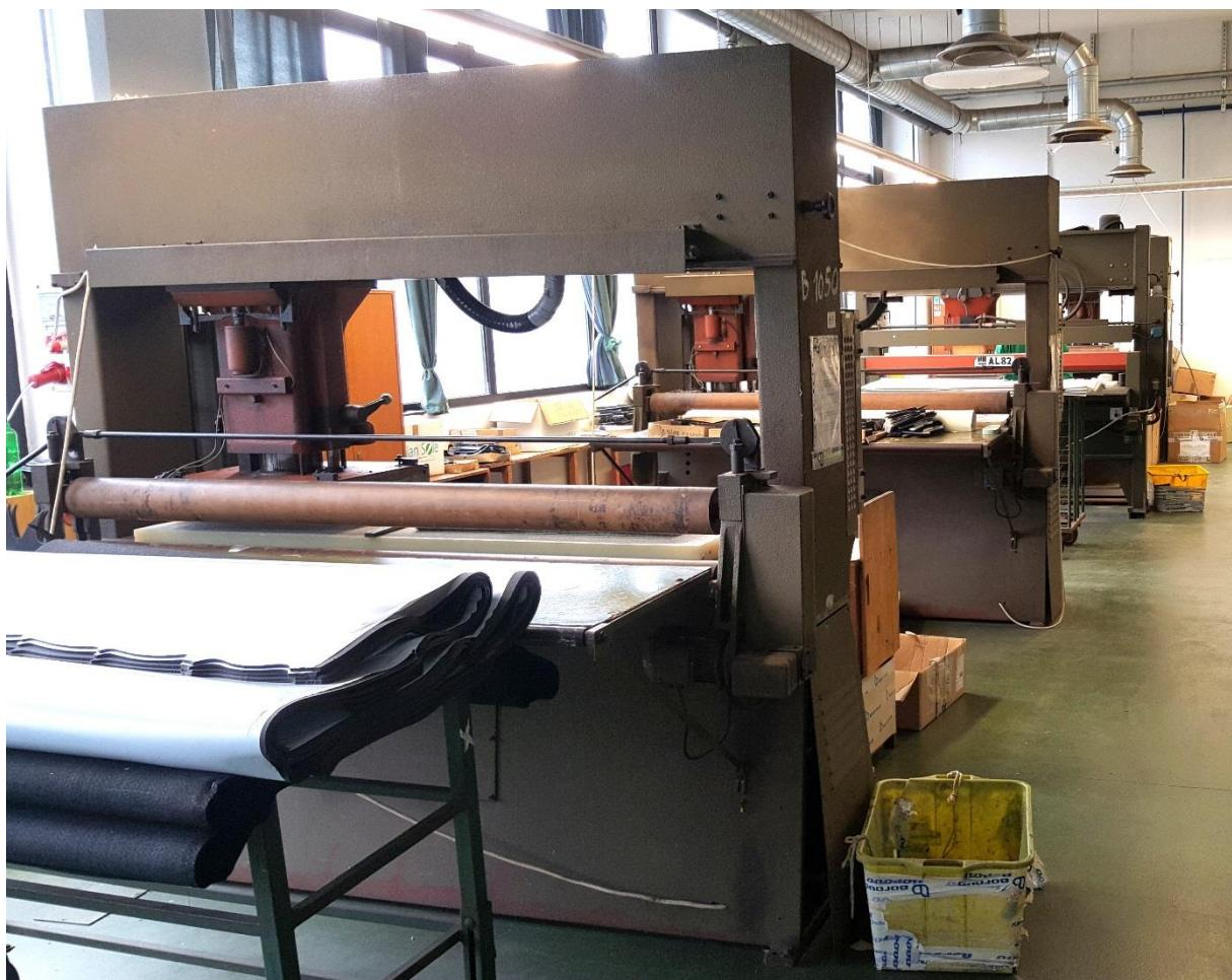
*Slika 3.8. Hidraulični mosni sjekački stroj Atom s trofaznim asinkronim motorom [2]*
