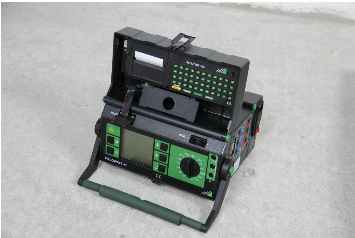
*Slika 4.6. Mjerni uređaj – PQ analizator Mavowatt 45 [5]*
