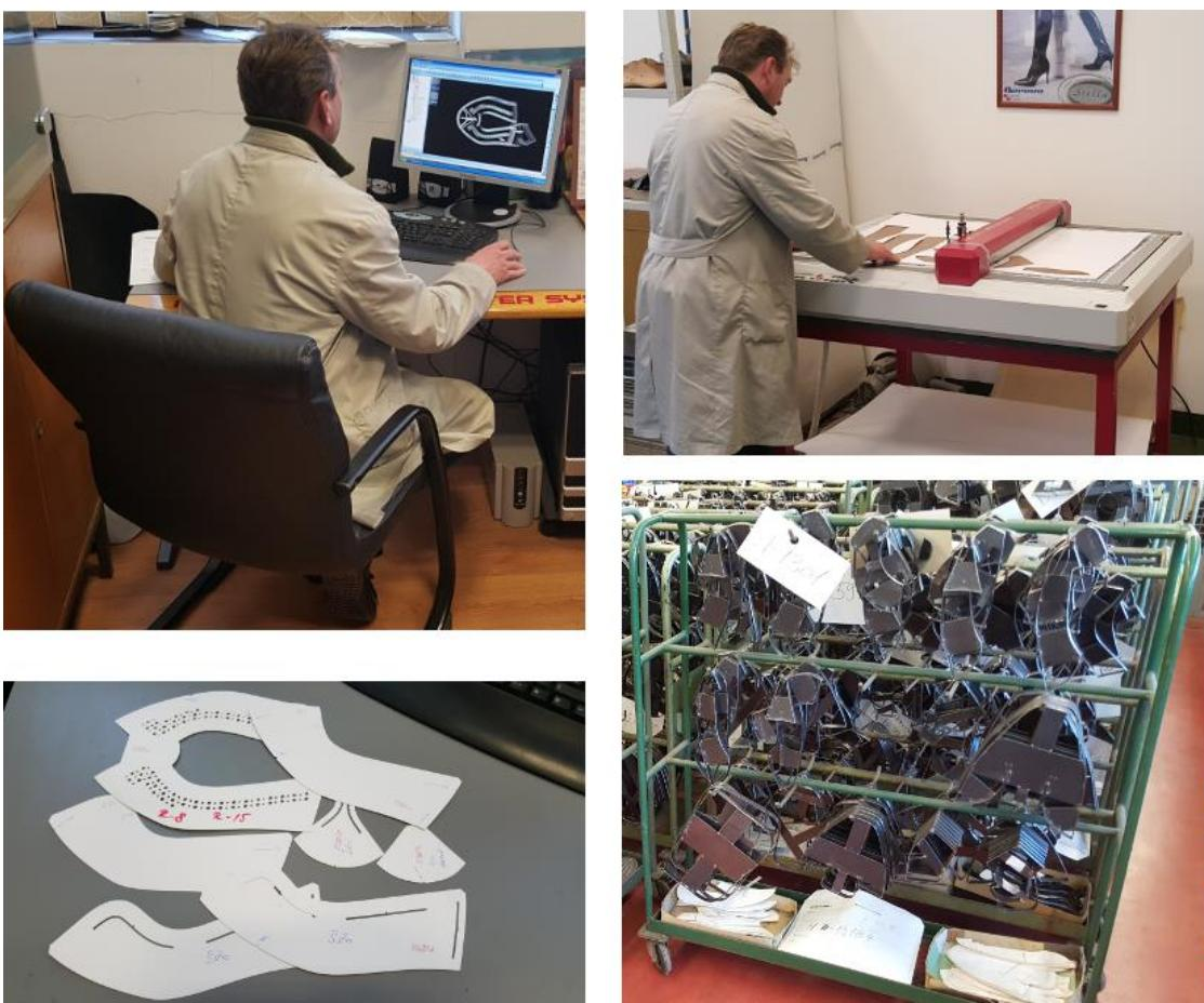
*Slika 3.6. Proces dizajniranja, isjecanja šablonu na sjekaču WILD TA-30 te gotovi noževi [2]*
