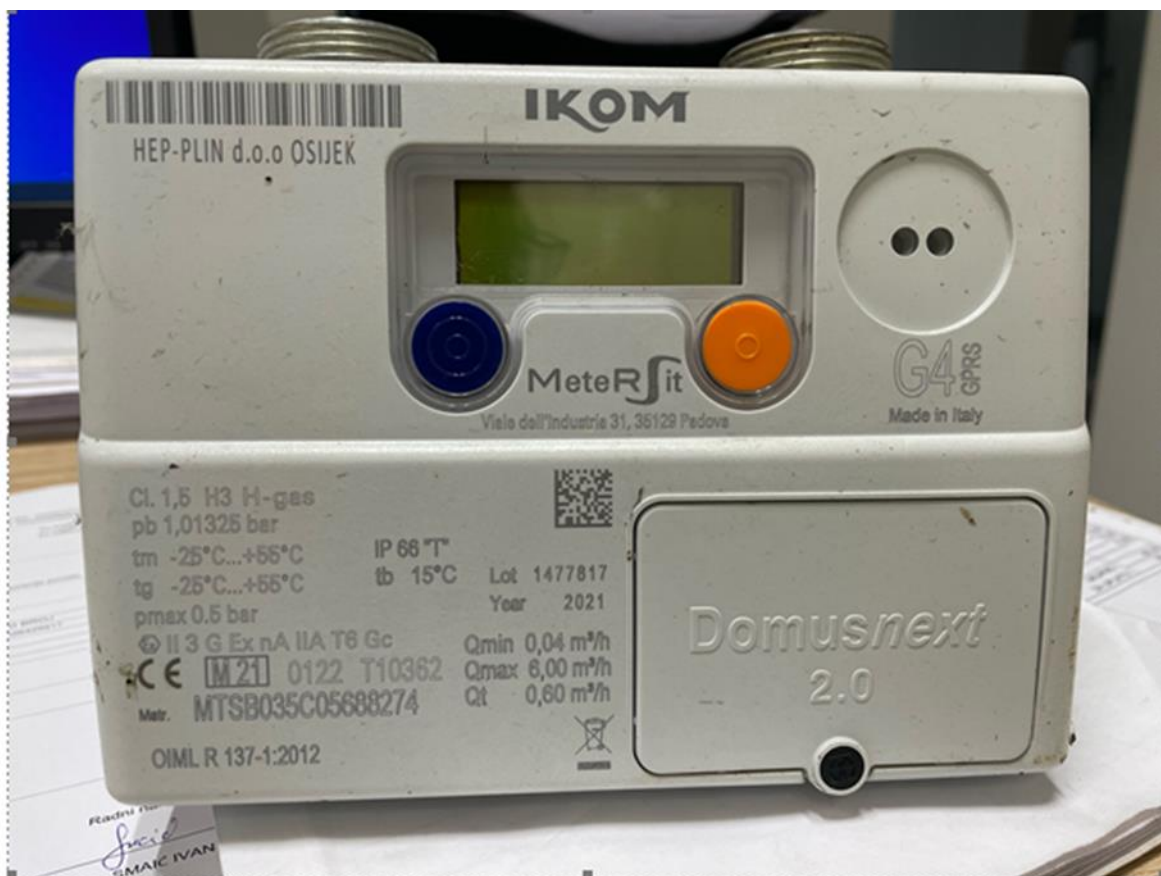
Slika 3.1: Mikrotermalni plinomjer za daljinsko očitavanje, Skladište HEP-Plin
