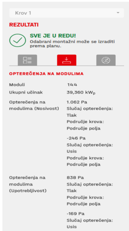
Slika 4.19. Prikaz opterećenja na modulima u programu K2 system base [13]
