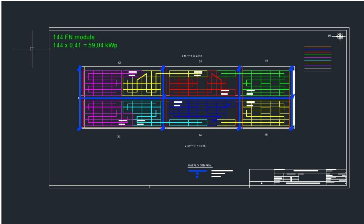
Slika 4.32. Prikaz izrade nizova i gromobrana u programu AutoCAD [15]
