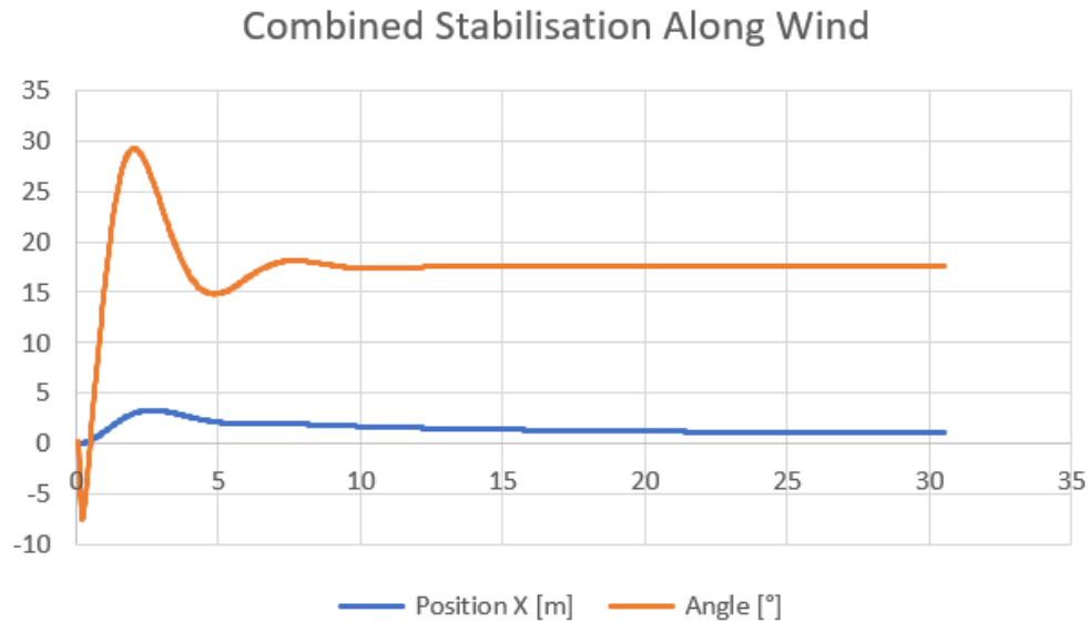
Slika 4.12 Horizontalna pozicija i kut letjelice u testu kombinirane regulacije u smjeru s vjetrom
