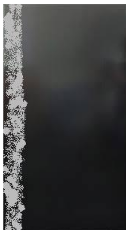
Slika 6.22. Zasjenjenje 1.stupca modula Solar Frontier SF-150.
