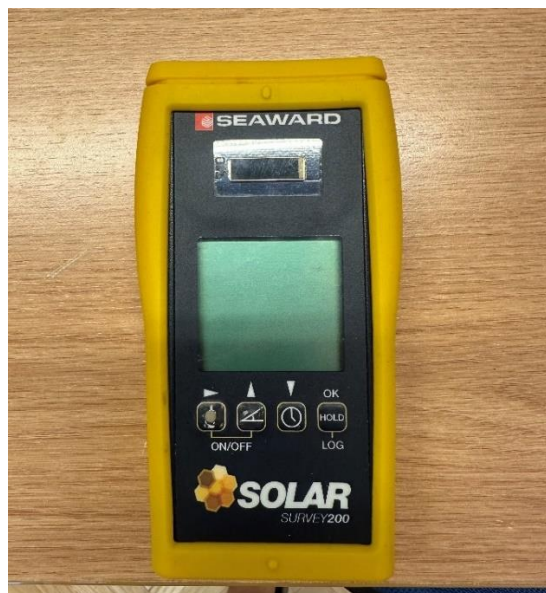
Slika 6.5. Piranometar Solar Survey 200
