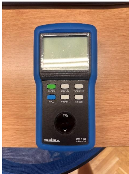
Slika 6.3. Vatmetar Metrix PX120
