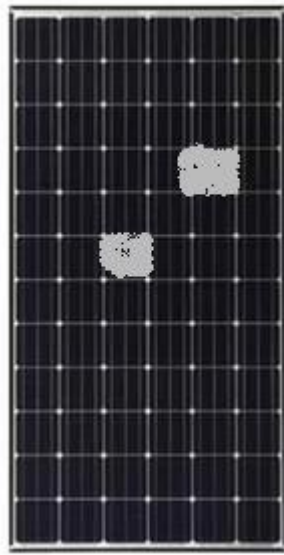
Slika 6.15. Zasjenjenje modula Panasonic VBHN240SE10 uzrokovano ptičjim izmetom
