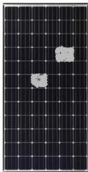
Slika 6.15. Zasjenjenje modula Panasonic VBHN240SE10 uzrokovano ptičjim izmetom
