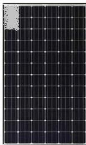
Slika 6.9. Zasjenjenje 2 ćelije FN modula Panasonic VBHN240SE10
