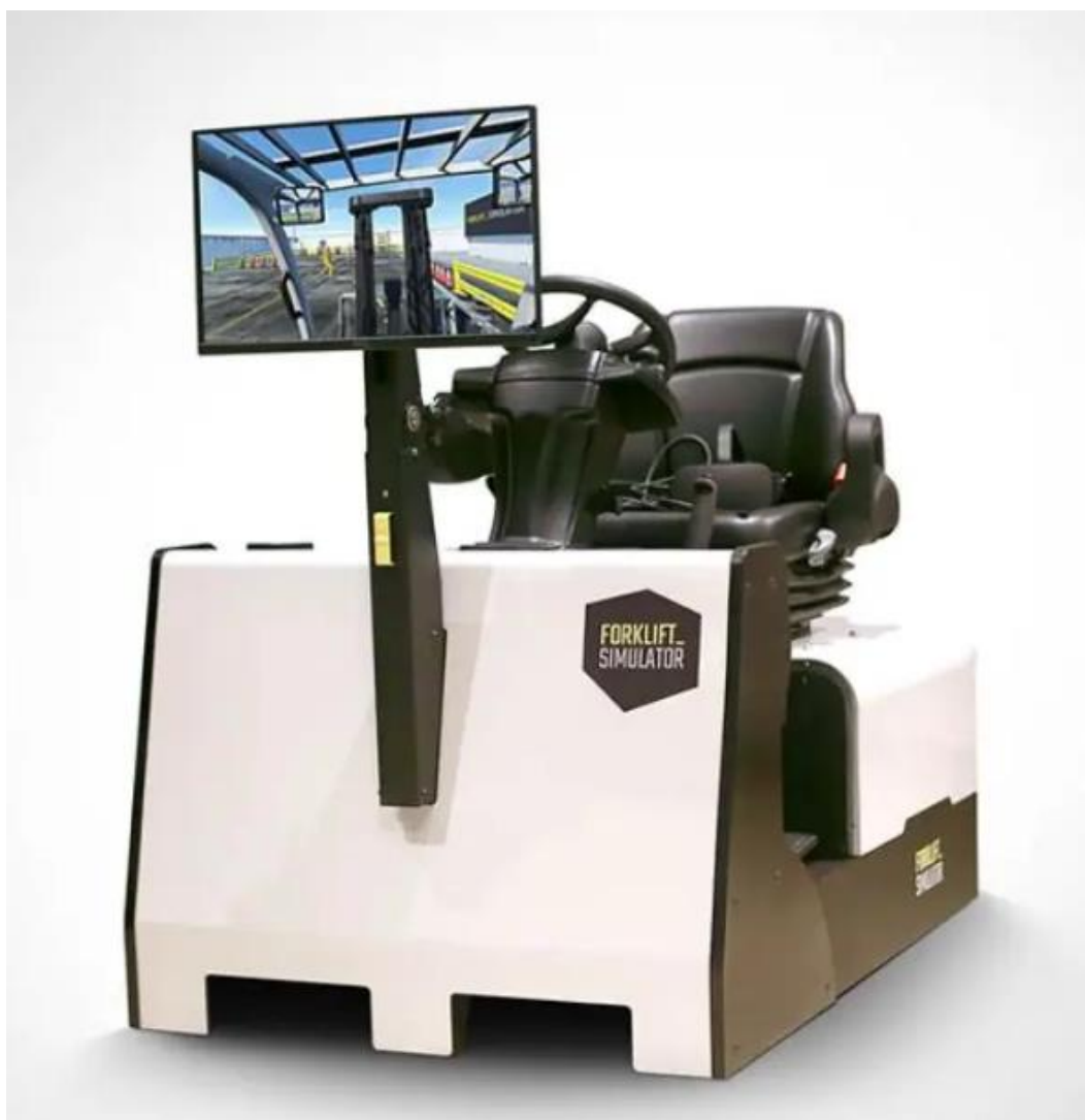
Slika 2.1. Prikaz Forklift simulatora [4]
