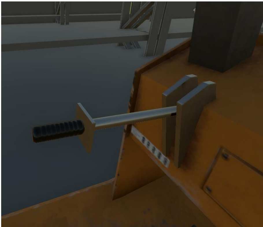
Slika 5.7. Spuštena parking kočnica
