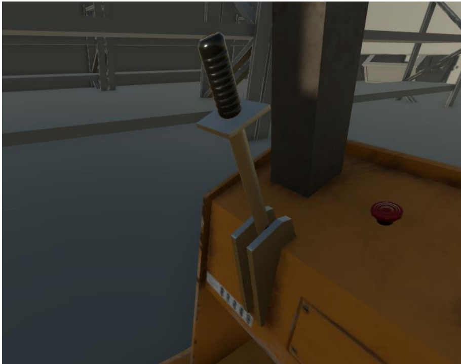
Slika 5.6. Podignuta parking kočnica
