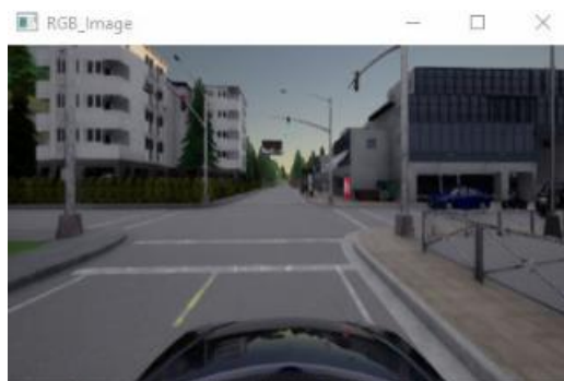
Slika 4.10: Primjer raskrižja gdje automobil nije uspio prepoznati paljenje zelenoga svjetla
