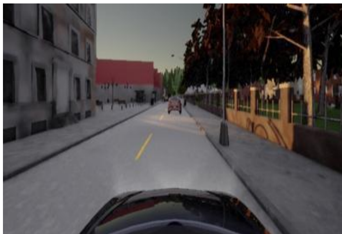
Slika 3.33: Primjer slike RGB kamere koja je pripremljena za proces treniranja modela, rezolucije 400x240
