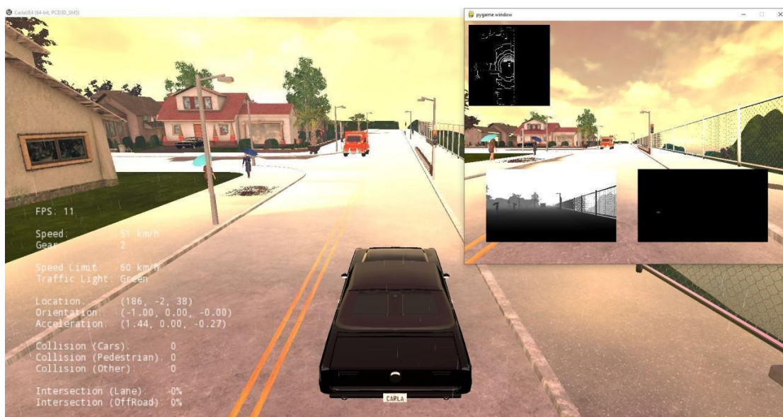
Slika 3.3: Prikaz rada nekih od mogućih senzora koji prate promatrani automobil
