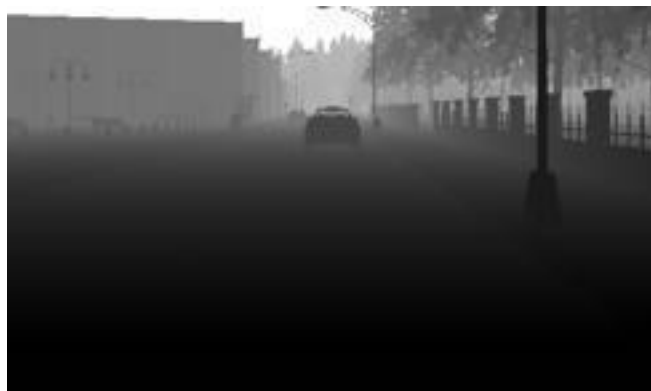
Slika 3.35: Primjer slike dubinske kamere nakon obrade slike prema zahtjevima za proces treniranja modela
