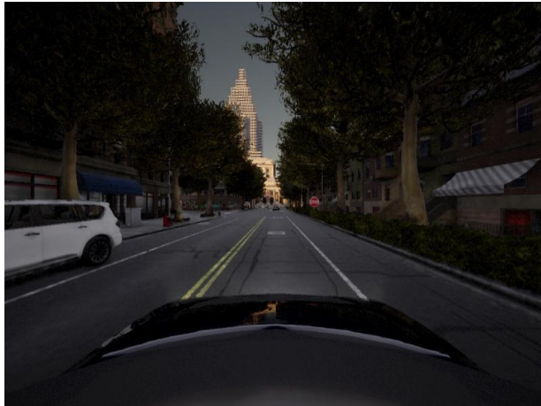
Slika 3.23: Primjer slike RGB kamere unutar CARLA simulatora s vidnim poljem od 110 stupnjeva
