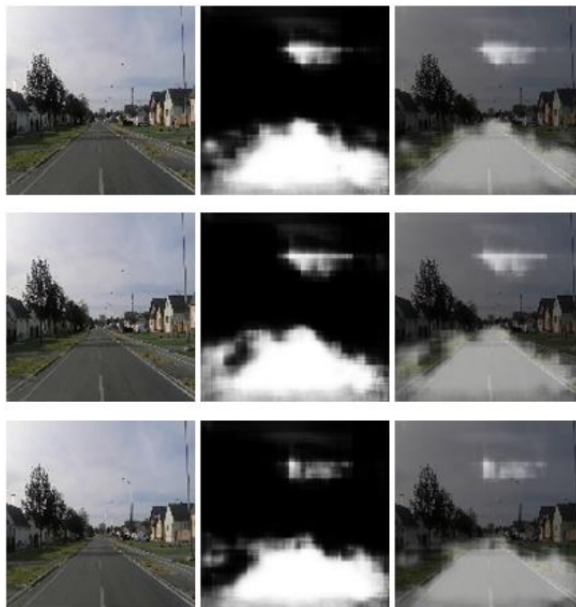
Sl. 4.4. Prikaz rezultata predviđanja modela semantic_model_cs1.h5 . Prvi stupac: ulazna slika, drugi stupac: predviđanje modela, treći stupac: overlay ulazne slike i predviđanja modela.
