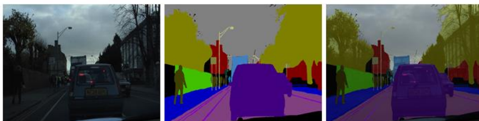
Sl. 2.7. Primjer iz CamVid skupa podataka. S lijeva na desno: originalna slika, segmentacijska mapa, preklapljena segmentacijska mapa preko originalne slike [21]
