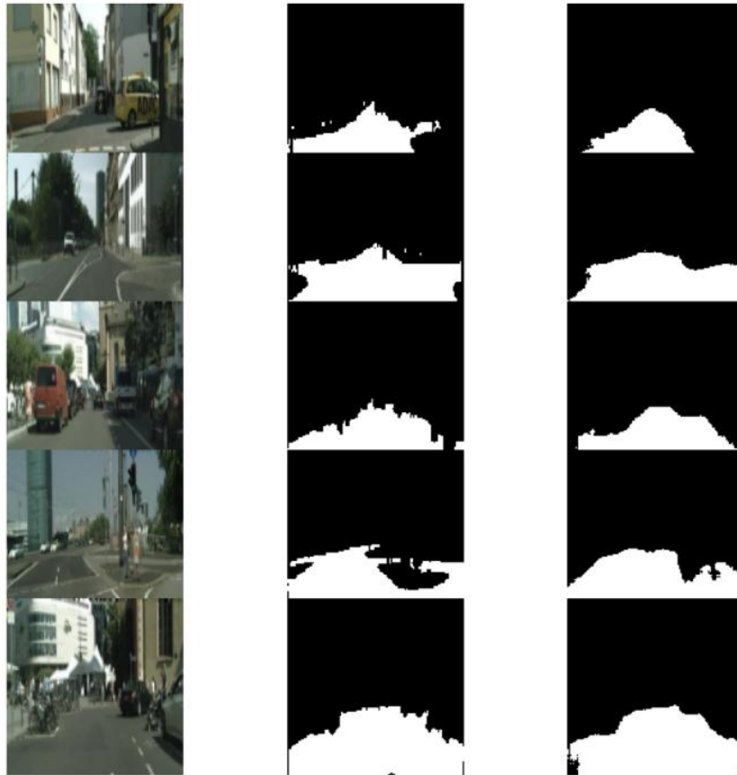
Sl. 4.1. Primjeri izlaznih maski za zadane ulazne slike iz Cityscapes validacijskog skupa podataka za dobiveni model prilikom treniranja semantic_model_cs1.tflite. S lijeva na desno: ulazna RGB slika, temeljna istina, predviđanje modela
