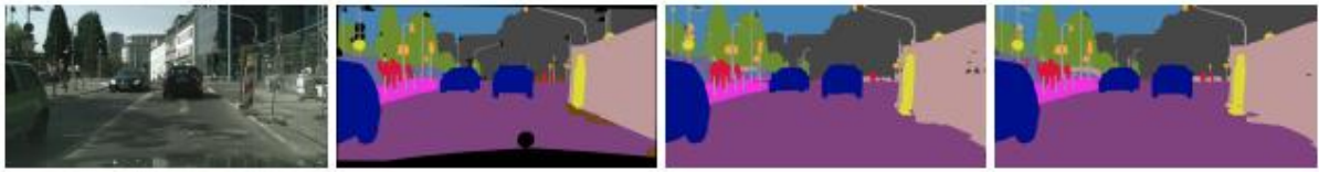
Sl. 2.13. Vizualizacija rezultata segmentacije na Cityscapes skupu podataka. S lijeva na desno; ulazna slika, temeljna istina, izlaz DDRNet-23-slim, izlaz DDRNet-23 [31].
