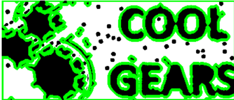
Slika 4.9. Prikaz filtriranih kontura na binarnoj testnoj slici
