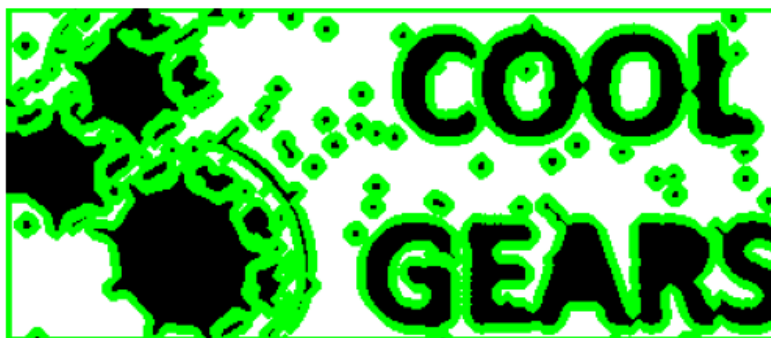
Slika 4.8. Prikaz detektiranih kontura na binarnoj testnoj slici
