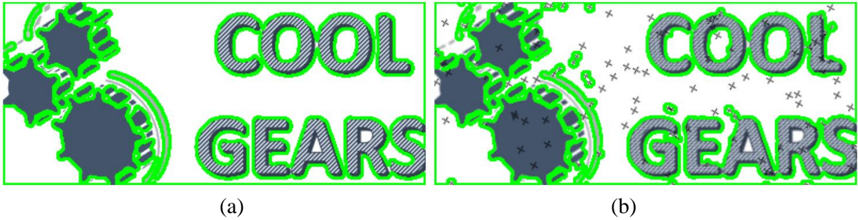
Slika 4.10. Prikaz detektiranih i filtriranih kontura (a) na referentnoj slici (b) na testnoj slici
