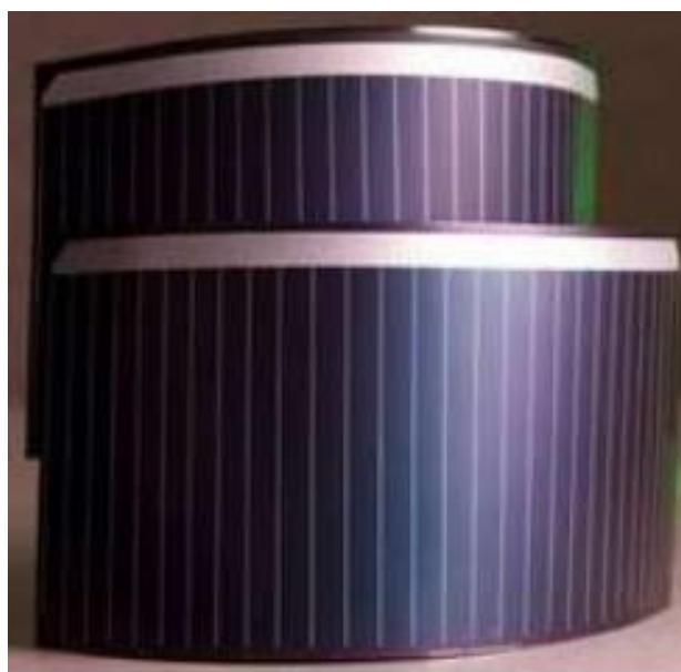
Slika 2.8. CI(G)S –Copper Indium (Gallium) Selenide solarna ćelija, [16]
