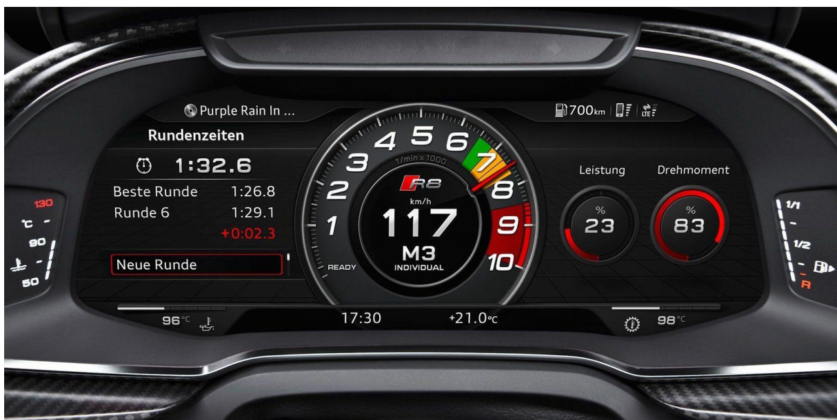
Sl. 2.2. Digitalni kokpit u automobilu Audi R8
