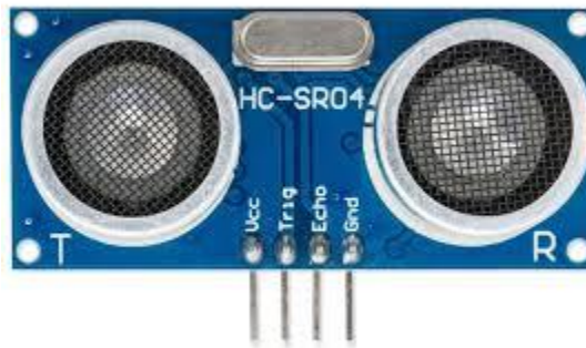
Slika 7.1. Ultrazvučni senzor HC-SR04
