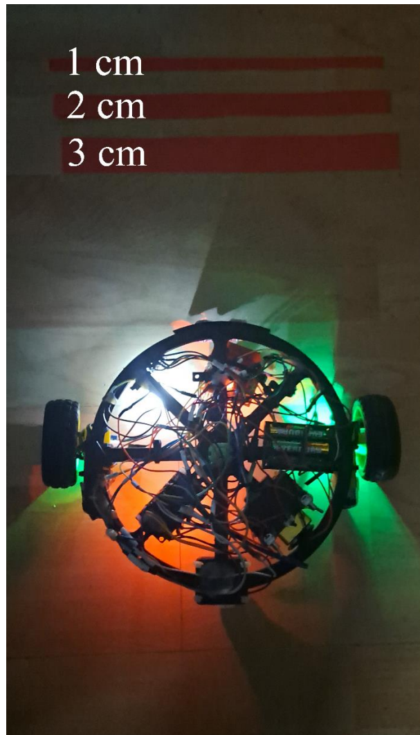
Slika 4.4. Testiranje debljine crte u mračnim uvjetima.
