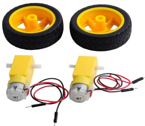
Slika 7.7. Pogonski motori i kotači
