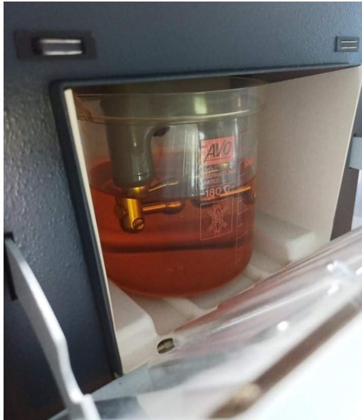
Slika 6.8. Uranjanje elektroda u uzorak broj 3
