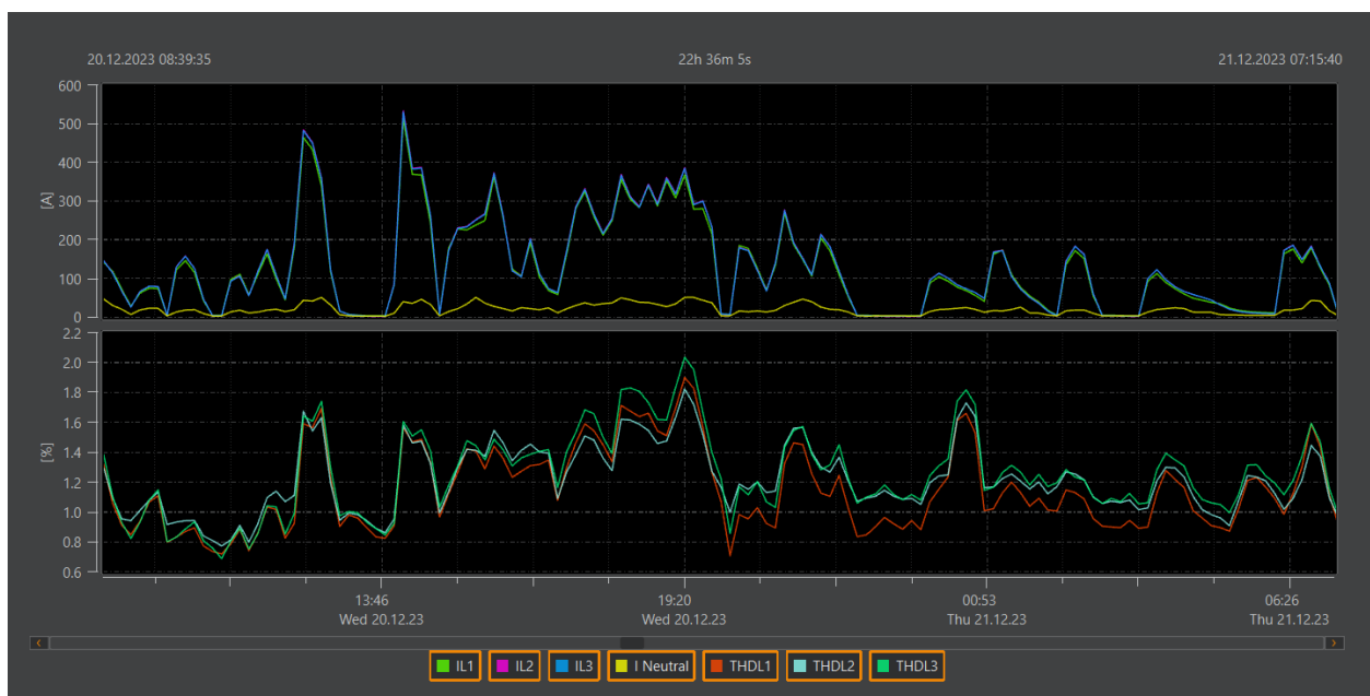
Slika 6.13. Grafički prikaz korelacijskog odnosa efektivnih vrijednosti struja ultra-brzog punjača i naponskog THD-a.
