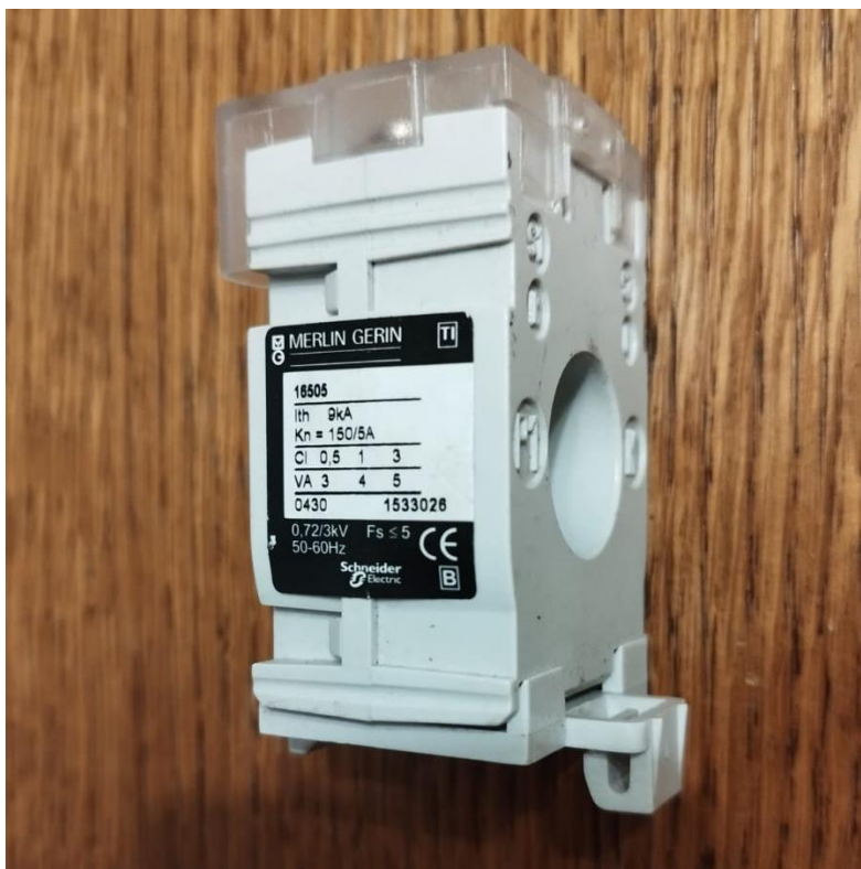
Slika 4.18 Strujni mjerni transformator.
