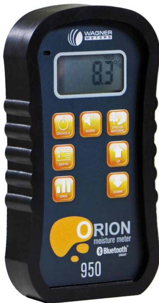
Slika 2.2 Wagner Meters Orion 950 mjerač bez igala za mjerenje
