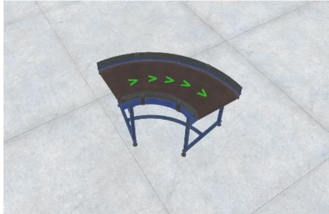
Sl. 5.31. Prikaz kutne pokretne trake
