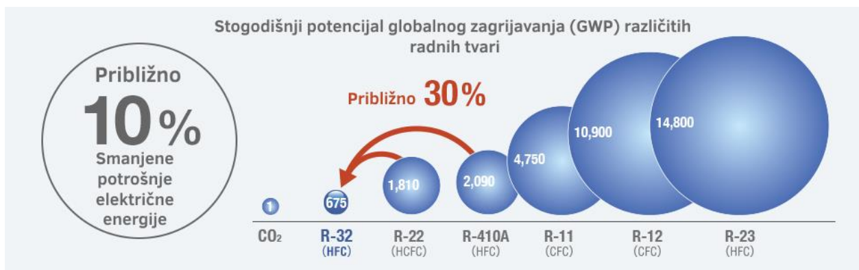
Slika 3.4. Vrijednosti za stogodišnji potencijal globalnog zagrijavanja [37].
