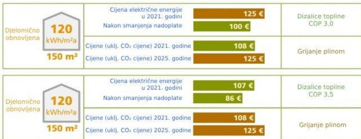
Slika 7.3. Usporedba mjesečnih troškova grijanja za dizalicu topline i grijanje plinom [69].
