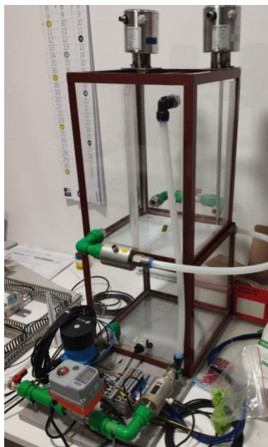
Slika 2.2. Pilot postrojenje za sustav skladištenja tekućine
