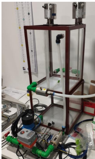
Slika 2.2. Pilot postrojenje za sustav skladištenja tekućine
