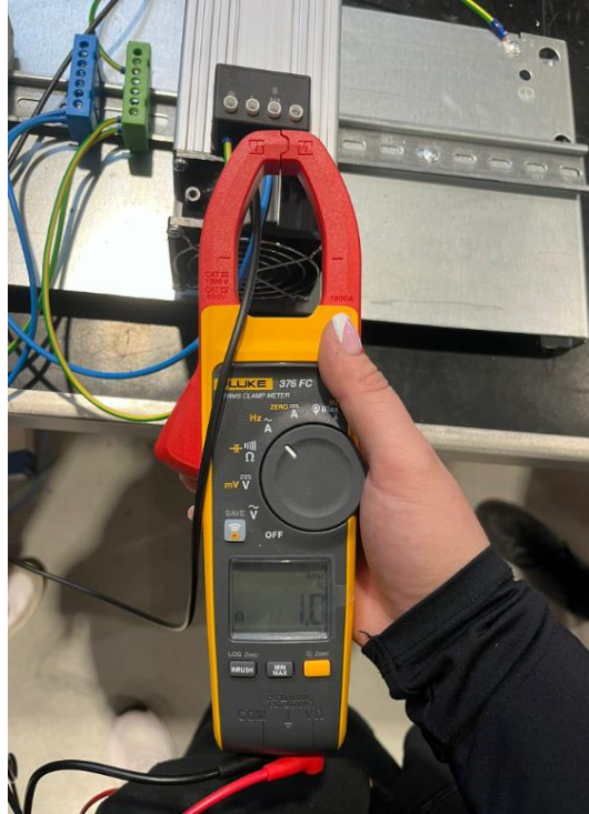
Slika 5.3.5. Mjerenje AC struje s FLUKE 376 FC strujnim kještima
