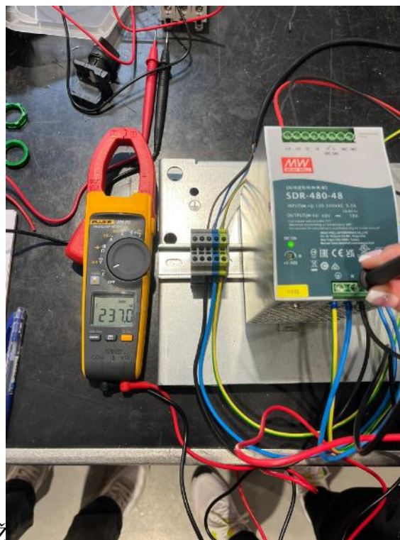
Slika 5.1.5. Mjerenje ulaznog napona s FLUKE 376 FC strujnim klještima
