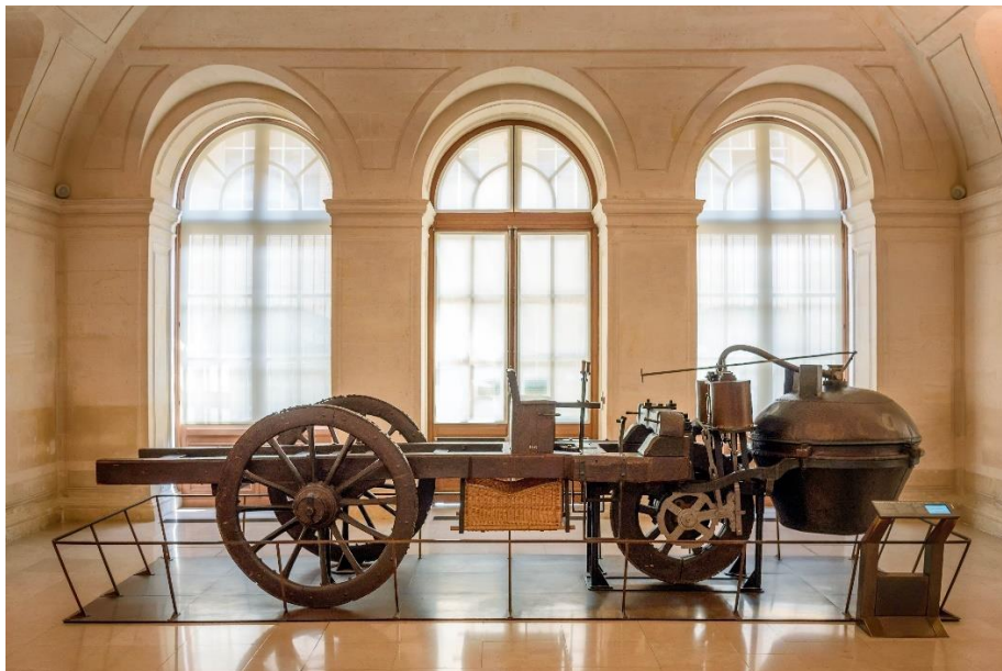
Slika 2.1. Replika Cugnotovog prvog samohodnog parnog vozila izložena u Musée des Arts et Métiers, Paris [3].
