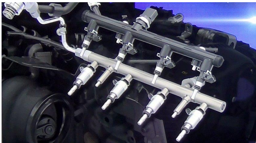
Slika 3.4. Prikaz sustava za ubrizgavanje goriva [24].
