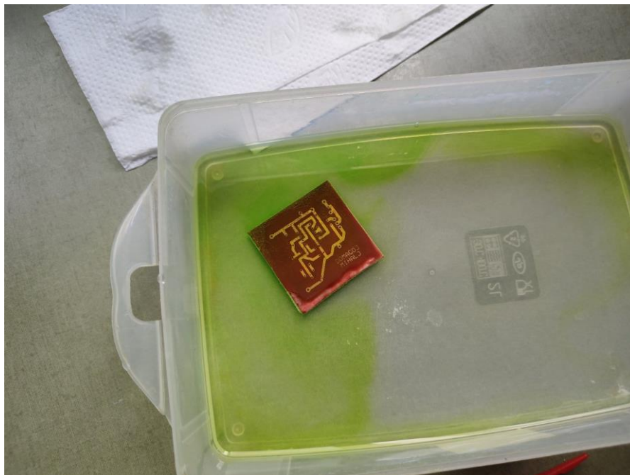
Slika 5.4. Jetkanje pločice u solnoj kiselini
