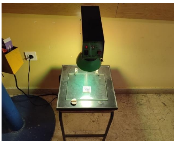
Slika 5.2. Osjetljivanje pločice UV lampom
