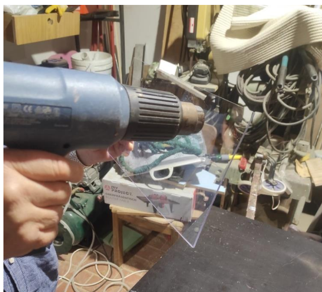
Slika 5.8. Zagrijavanje postolja prije savijanja
