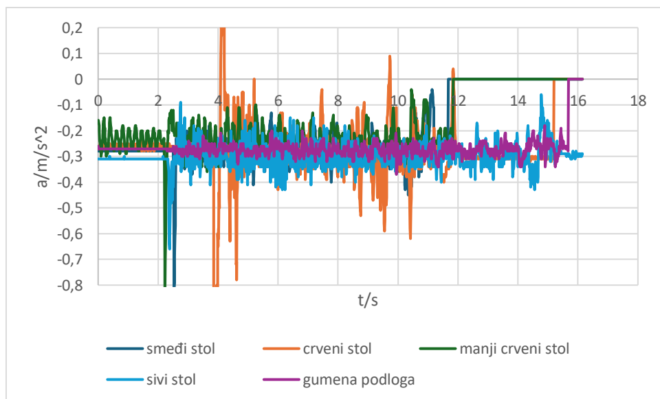
Slika 4.13. Grafički rezultati povlačenja uže strane drvene pločice
