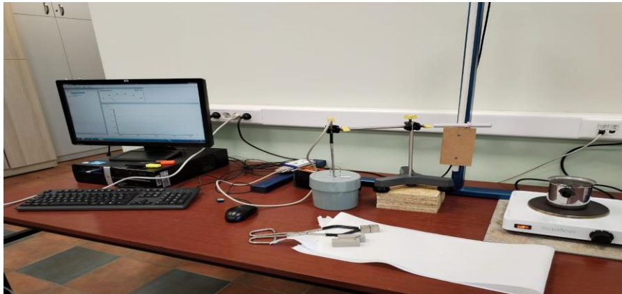
Slika 4.7. Postav eksperimenta koliko topline se može uskladištiti u metalima
