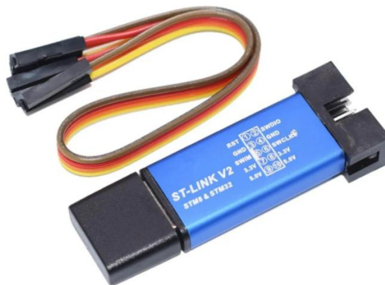
SI. 3.8. ST-LINK V2 Programer za Preuzimanje Simulatora (engl. ST-LINK V2 Simulator Download Programmer ) [9]
