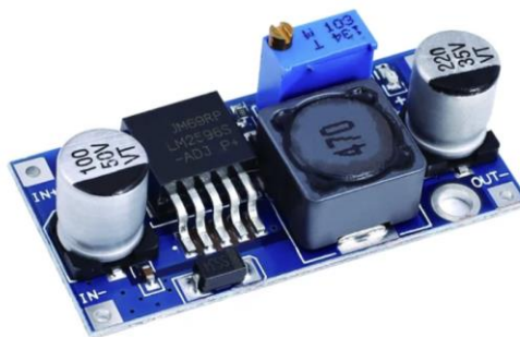
Sl. 3.5. LM25956S-ADJ DC/DC silazni Pretvarački Modul (engl. LM2596S-ADJ DC/DC Step-down converter module ) [6]
