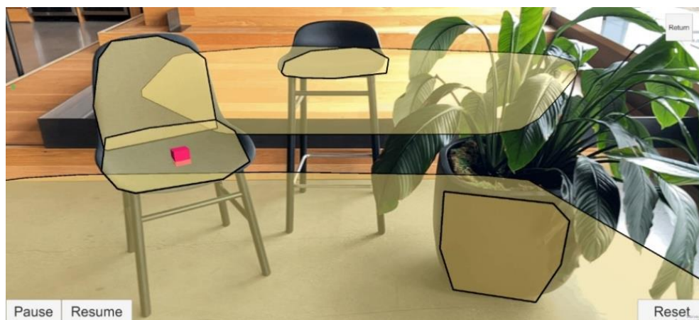
Slika 6. Primjer scene za detekciju površina i raycast unutar AR Foundationa [10].
