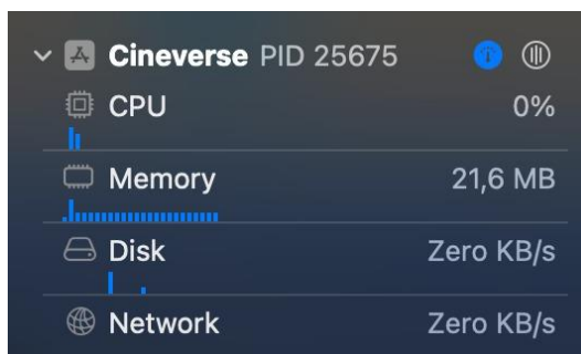
Slika 3.2. Praćenje performansi pokrenute aplikacije u XCode „Debug Navigator“ odjeljku.
