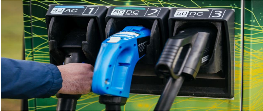
SI 2.4. Primjer priključaka na punionicama [20]
