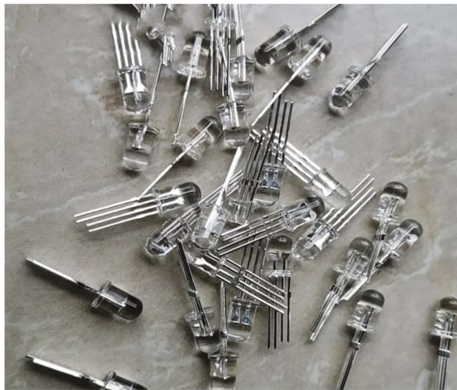
Sl. 3.2. Prikaz korištenih WS2812D F-5 dioda [12].
