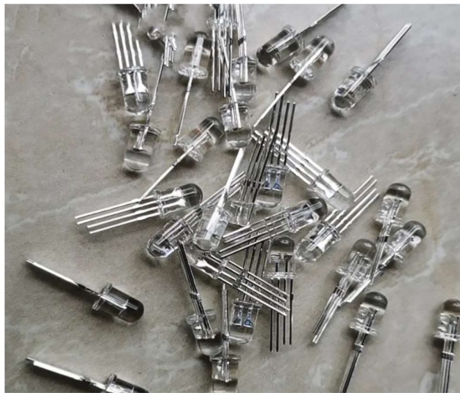
Sl. 3.2. Prikaz korištenih WS2812D F-5 dioda [12].
