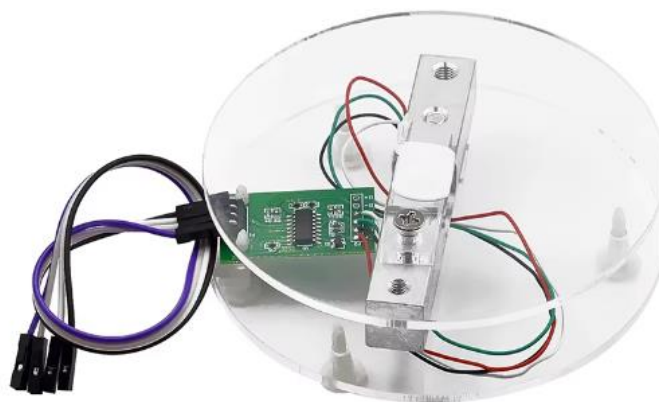
Slika 3.7. load cell(mjerna ćelija)
