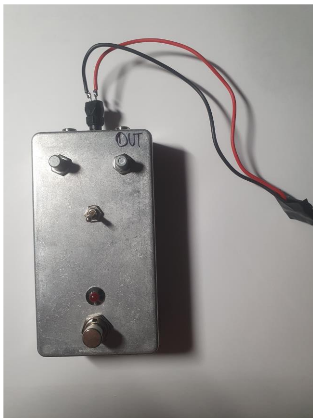
Sl. 4.5. Prikaz sklopljene efekt pedale
