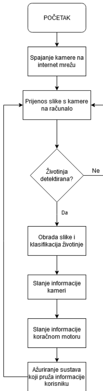
Slika 2.5. Zamišljeni blok dijagram programskog rješenja.
