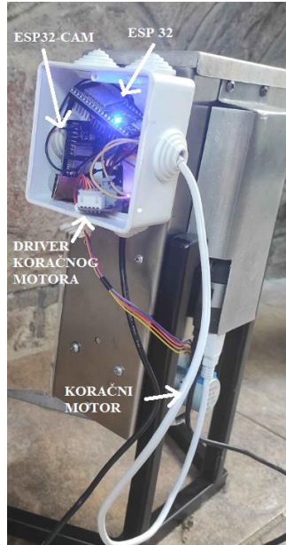
Slika 3.8. Komponente ugrađene na hranilicu.
