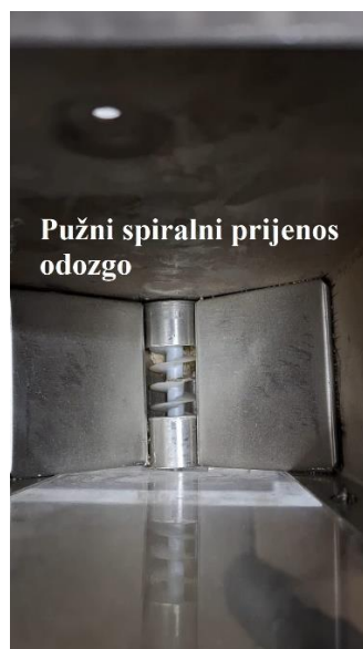
Slika 3.6. Pužni spiralni prijenos (prva verzija).
