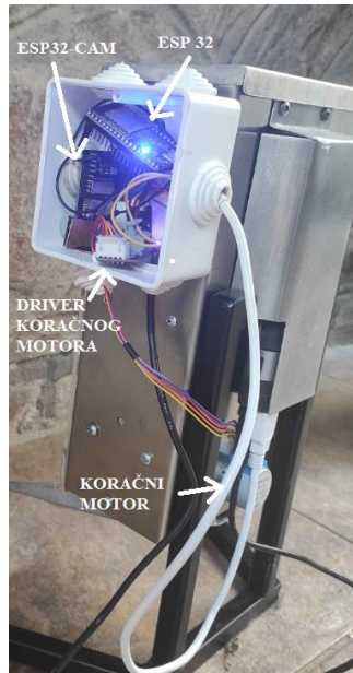
Slika 3.8. Komponente ugrađene na hranilicu.
