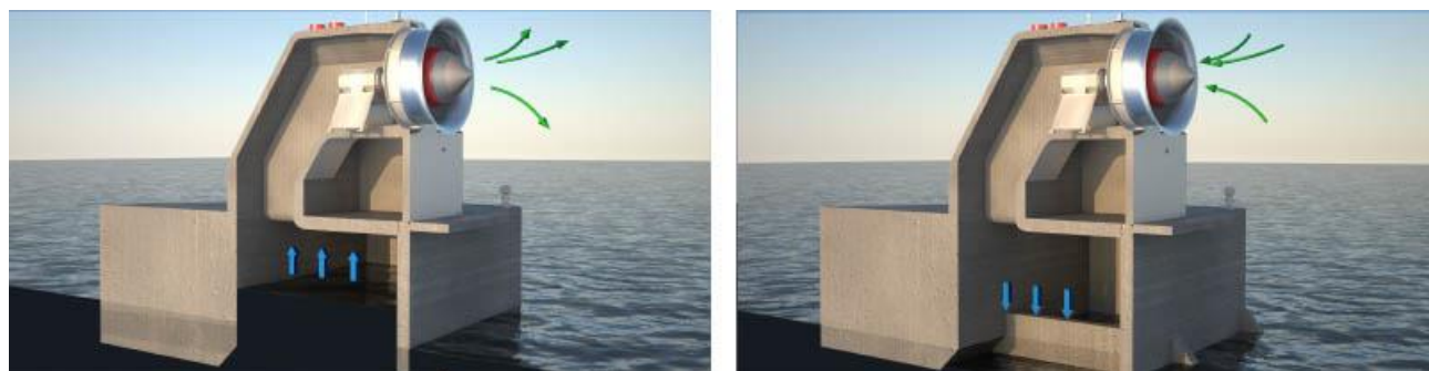
Slika 2.2.2. Postrojenje na morske valove Oceanlix. [12]
