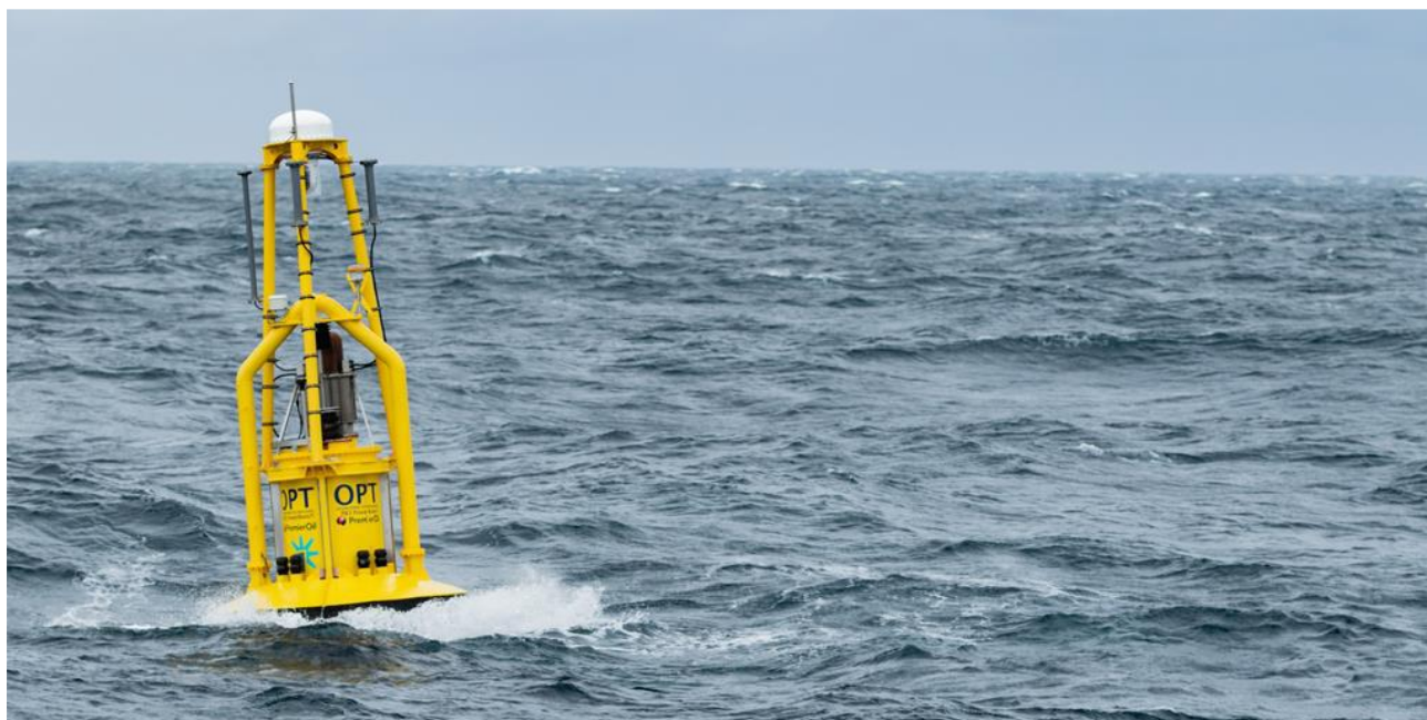
Slika 2.2.10. Power buoy oscilirajuće tijelo. [4]
