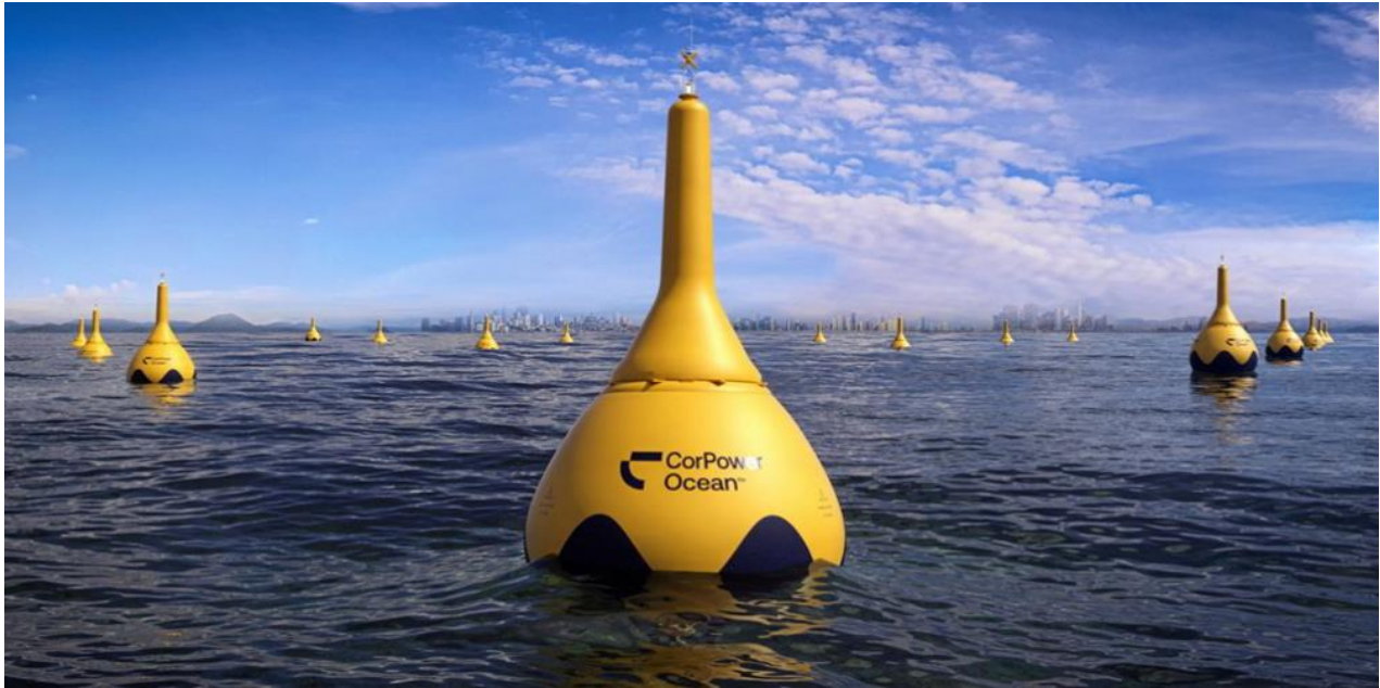
Slika 2.2.7. The CorPower Ocean C4. [18]
