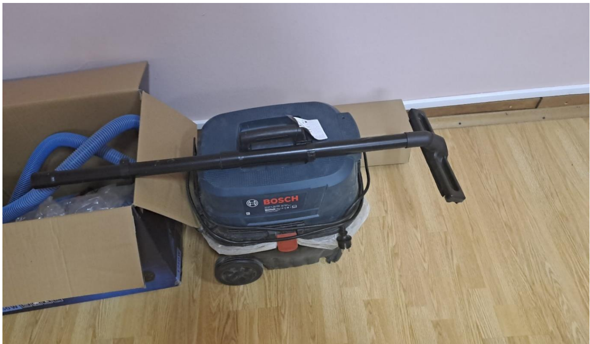
Slika 6.7 Usisivač za čišćenje pod naponom
