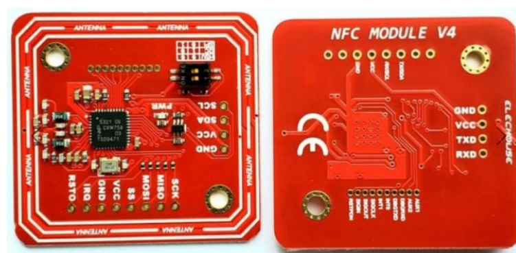
Slika 3.3. Izgled PN532 NFC RFID Module V4 modula [5]
