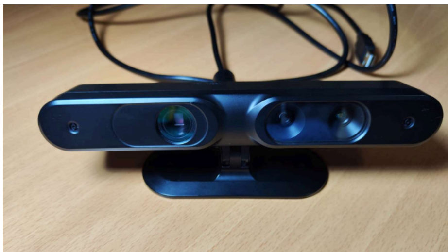
Slika 3.3: ASUS Xtion PRO Live kamera.
