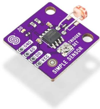
Slika 3.1. Fotootpornik koji se koristi u izradi
