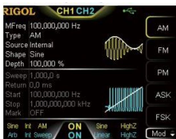
Slika 2.7. Prikaz ugrađenih modulacijskih postupaka funkcijskog generatora.
